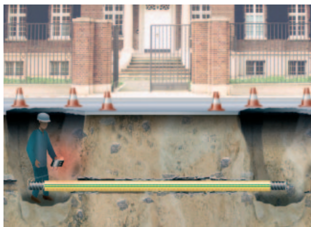
Abb 1-2: Nachweis auf Nichtbeschädigung mit einem Durchgangsprüfer
