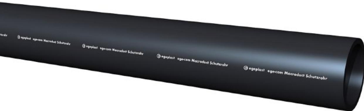
Die ege-com® Macrodut Schutzrohre für Steuerleitungen sind zum Einpflügen, Einfräsen, Einziehen im Horizontal-spülbohrverfahren, sowie für die offene Bauweise geeignet. Die Maße und Toleranzen von Außendurchmesser (OD) 50 bis 225 mm, SDR 11 und 17,6, entsprechen der DIN 16874. Maße und Toleranzen OD 250 mm bis 400 mm, SDR 11 und 17,6 entsprechen der DIN 8074.
