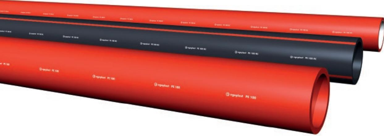
Das egeplast Standard-Rohr ist ein Rohrsystem aus PE 100 oder PE 100-RC. Es kann in verschiedenen Ausführungen mit Streifen oder mit maßlich integrierter, farbiger Außenschicht zur Kennzeichnung des Mediums geliefert werden. Abhängig vom eingesetzten Werkstoff ist es für die offene Verlegung mit und ohne Sandbett sowie für Pflug- und Fräsvorfahren geeignet.
