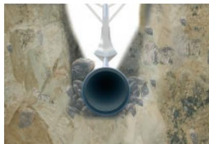
Sandbettfreie Verlegung, Pflug- und Fräsvorfahren / Open trench installation without sandbed, ploughing and milling
