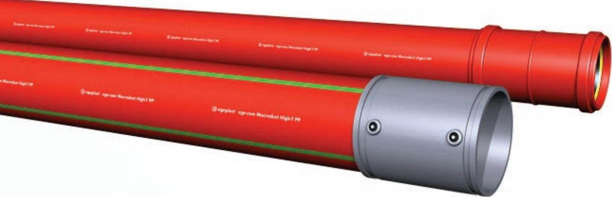
Das ege-com® Macrodut High-T PP ist ein Schutzrohr aus Polypropylen mit Steckmuffe für eine wirtschaftliche Verlegung im offenen Graben. Eingesetzt wird das dichte System für Hoch- und Höchstspannungskabel bis zu 525 kV. Durch einen modifizierten PP Werkstoff verfügt das System über eine erhöhte Wärmestabilität, um hohen thermischen Beanspruchungen lange standzuhalten. Stromnetzbetreiber sichern sich so einen langfristigen Werterhalt ihres Netzes.
