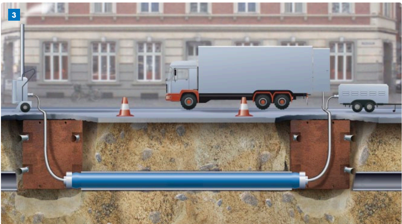
Aufweitung des egeLiners mittels Wasserdampf / Resizing the egeLiner® using hot steam
