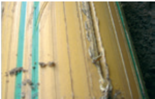
Abb. 1 a: Axiale Riefen im Schutzmantel, der Verschleißschicht, auf einem einge-zogenen Schutzmantelrohr
