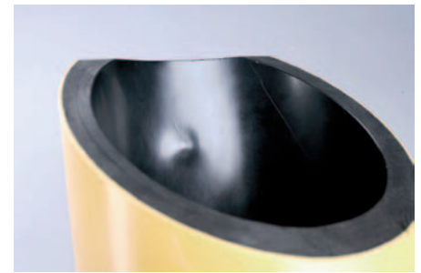
Bild 4: egeplast 9010 RCplus-Rohr nach einem Jahr Punktlastprüfung ohne Bruch (80°C, \sigma = 4 MPa)
