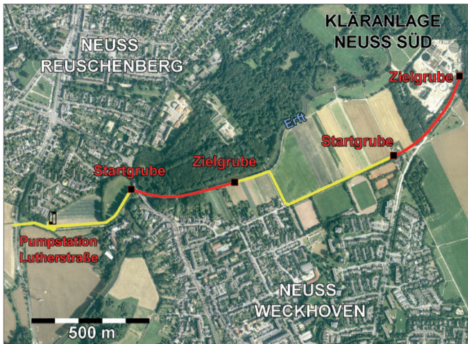
2,5 km Abwasserleitung von der Pumpstation bis zur Kläranlage Neuss Süd
