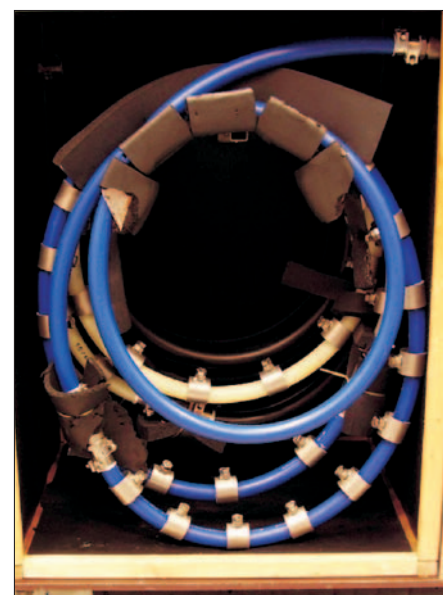
Bild 9: Durchlaufapparat zur Prüfung der Wärmealterung
