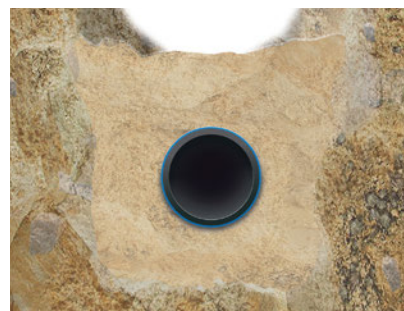
Offene Verlegung im Sandbett Open trench installation with a sand bed
