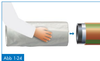
Abb 1-24 Schrumpfmuffe vor der Herstellung der Rohrverbindung aufschieben, Schutzfolie nicht entfernen
