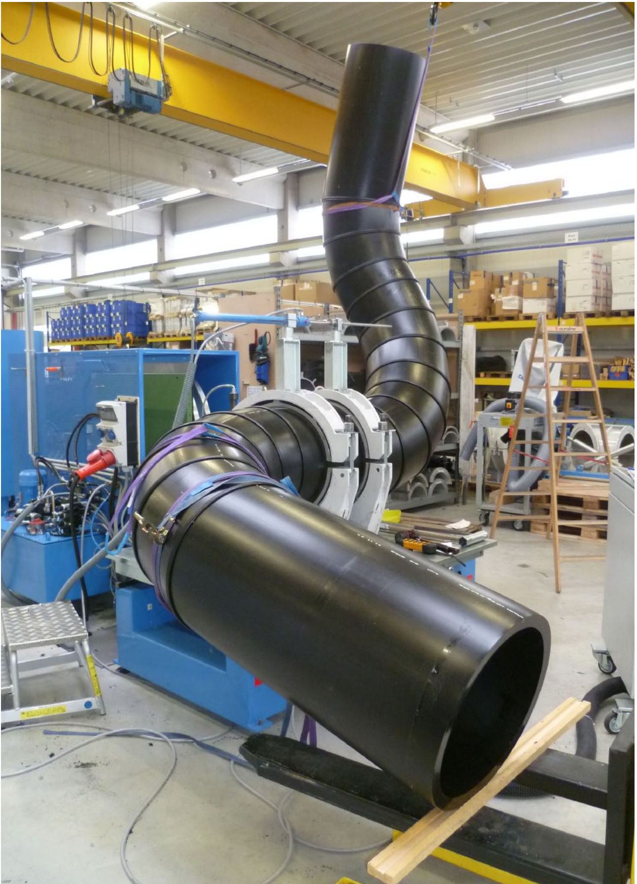
Segmentbogen OD 560 mm in drei Ebenen abgewinkelt Segmented bend OD 560 mm angled at three levels
