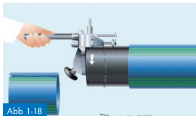
Abb 1-18 Entfernen der Oxidschicht mittels Rotationschälgerät
