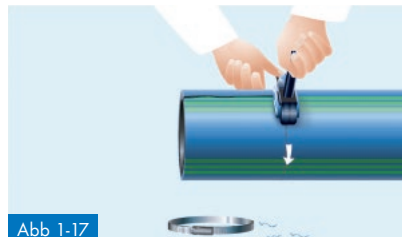
Abb 1-17 Entfernen des Schutzmantels mit dem egeplast Schälgerät M10 / M10 maxi
