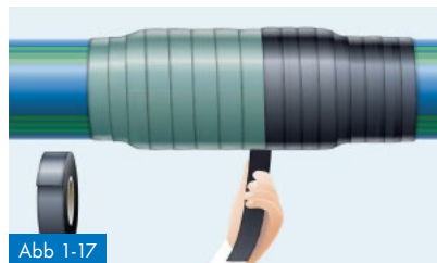
Abb 1-17 Schritt 2: exemplarisch: Mechanischer Schutz der Isolationsschicht
