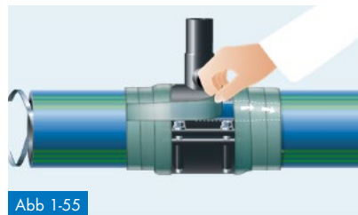
Wasserdichte Isolation der elektrischen Verbindungsstelle
