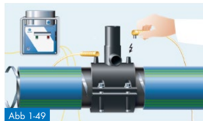
Abb 1-49 Schweißen gemäß DVS 2207, Teil 1
