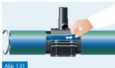
Abb 1-51 Wiederherstellen und Fixieren der elektrischen Verbindung
