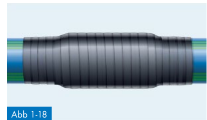
Abb 1-18 Mechanisch geschützte/isolierte Verbindungsstelle
