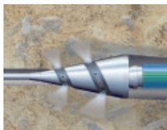
Black-Box-Verlegung wie Spülbohrung, Berstlining, Relining und Bodenverdrängung
