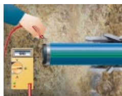
Nachweis auf beschädigungsfreien Einbau nach Verlegung
