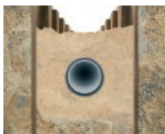
offene Verlegung im Sandbett
