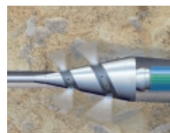
Black-Box-Verlegung wie Spülbohrung, Berstlining, Relining und Bodenverdrängung
