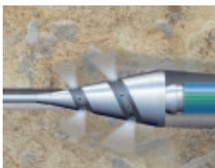
Black-Box-Verlegung wie Spülbohrung
