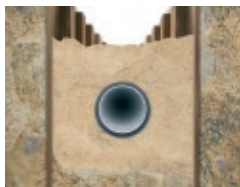
offene Verlegung im Sandbett
