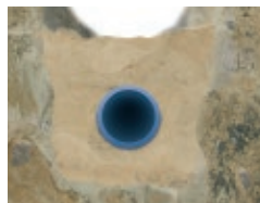
offene Verlegung im Sandbett
