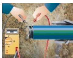
Nachweis auf beschädigungsfreien Einbau nach Verlegung
