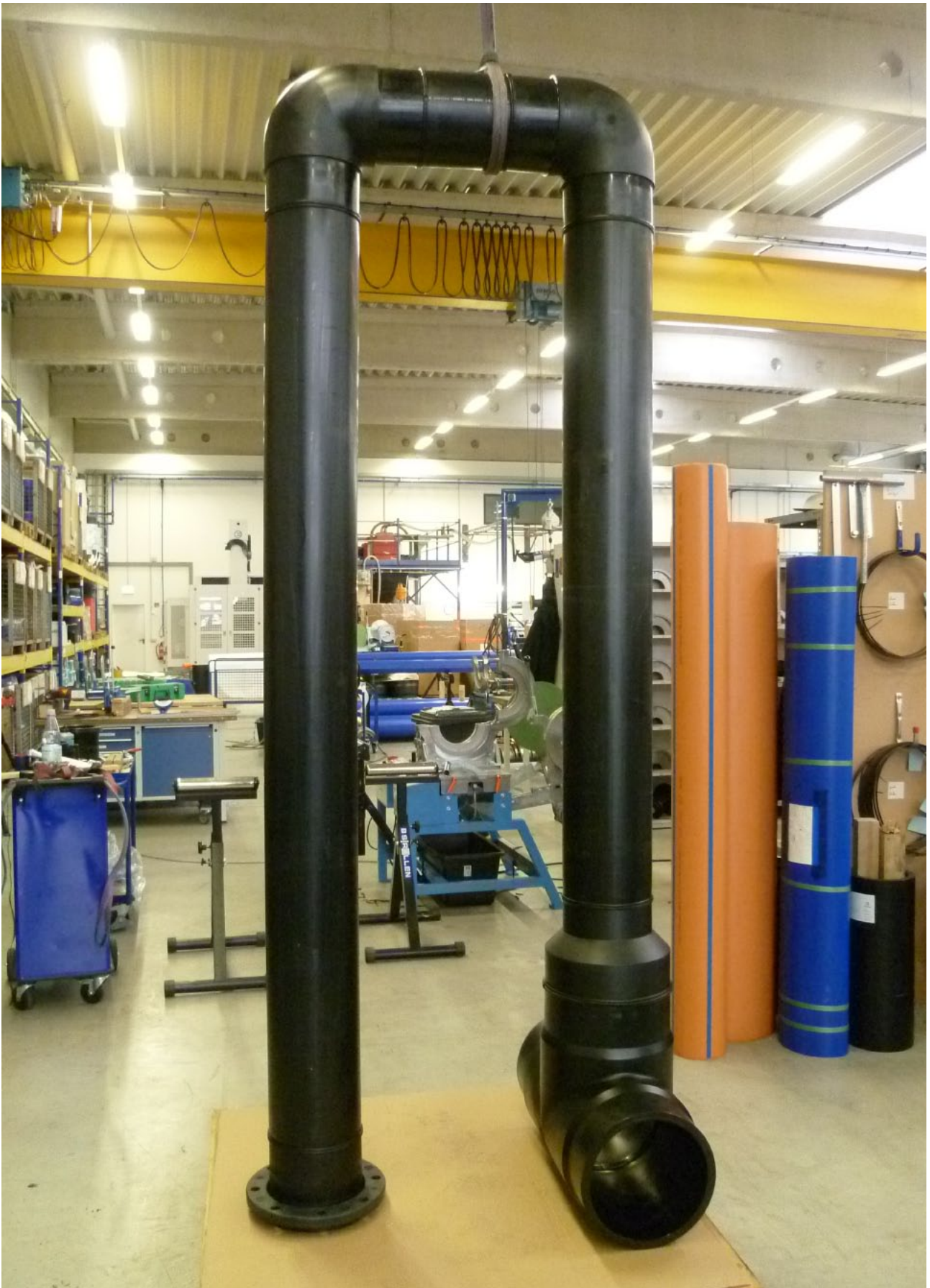
Salzwasser-Umlenkverteiler OD 280 mm mit Vorschweißbund und Losflansch, 90°-Bögen und T-Stück OD 225 mm Saltwater manifold OD 280 mm with stub end and loose flange, 90° elbows and T-piece OD 225 mm
