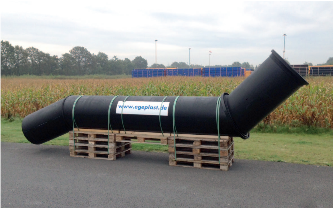
Etagenbogen OD 800 mm mit Vorschweißbund und Losflansch nach Kundenvorgaben Swan-neck bend OD 800 mm with stub end and loose flange according to customer specification
