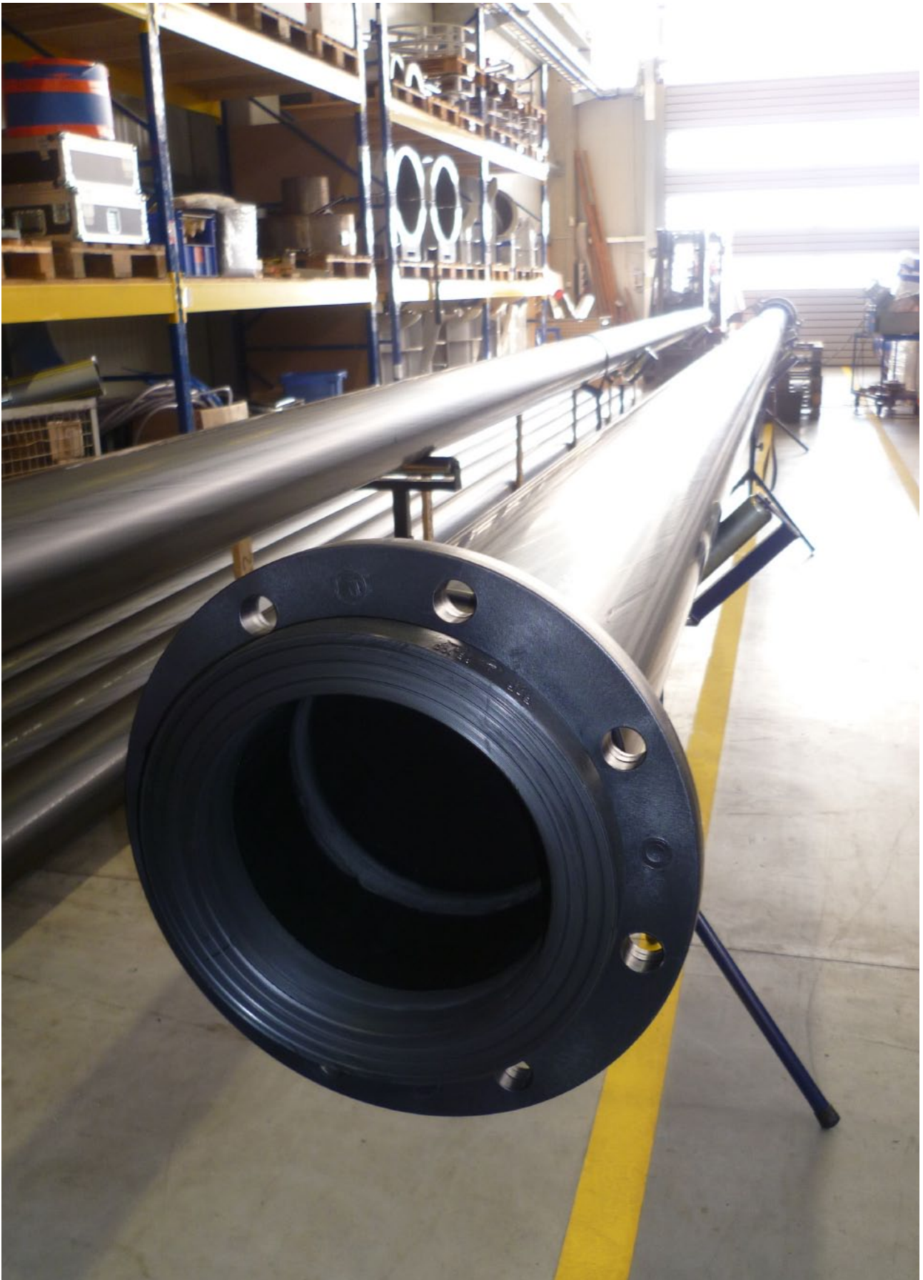
Flanschenrohre OD 280 mm Flanged pipes OD 280 mm
