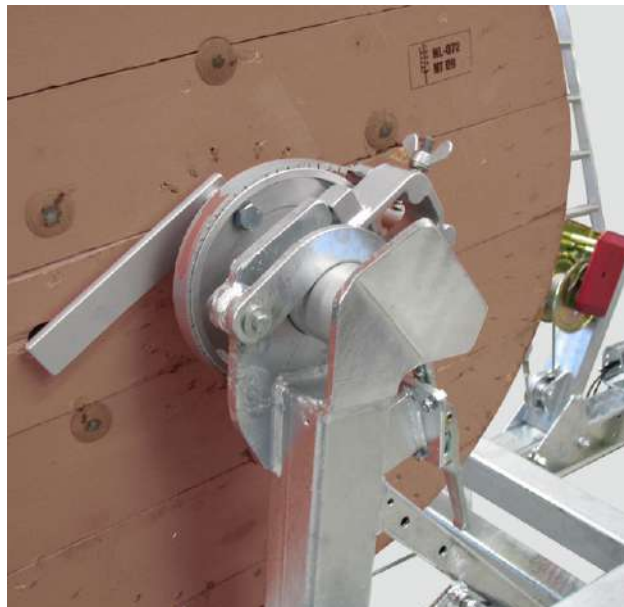
Trommelbandbremse der Firma Vetter
