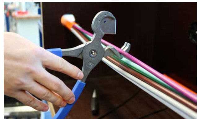
4. Das zu schneidende Rohr mit dem Rohrschneider rechtwinklig durchtrennen.
