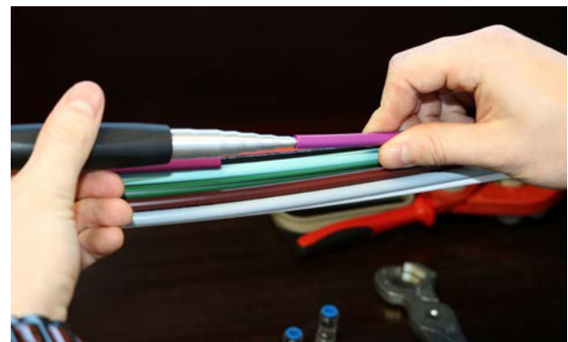
6. Die Schnittstellen mit dem Tool 5/20 runddrücken.
