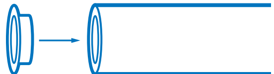
Sichere Lagerung: Mit verschlossenen Rohren
