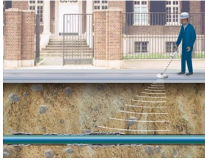
Schadens- / Leitungsortung Damage / pipeline detection
