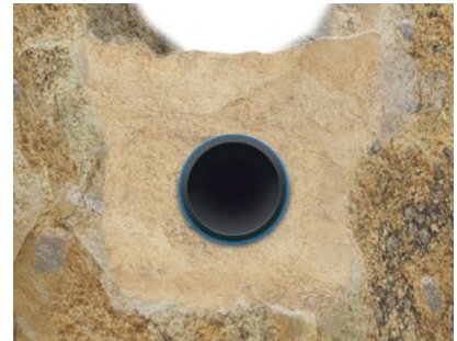
Offene Verlegung im Sandbett Open trench installation with a sand bed
