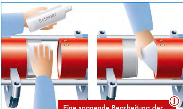
Reinigung der Schweißflächen
