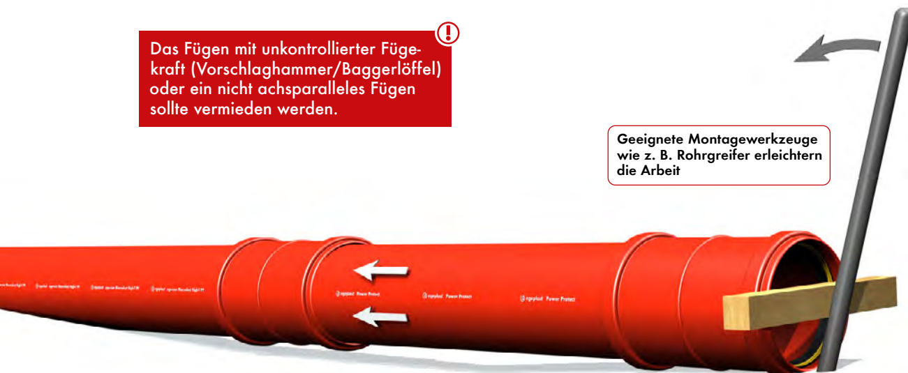
Einschieben der Muffenverbindung durch Einhebeln
