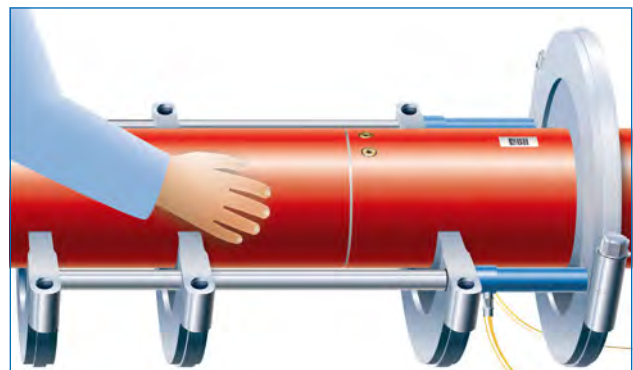
Priorisiert wird ein Einfügen des Spitzendes in die Muffe
