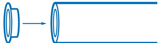
Sichere Lagerung: Mit verschlossenen Rohren
