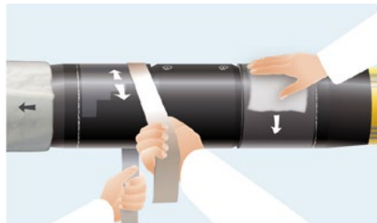
Abb. 2.14 Schrumpfbereich der Muffe radial mit Schmirgelleinen aufräumen, anschließend reinigen und trocknen
