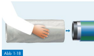
Abb 1-18 Schrumpfmuffe vor der Herstellung der Rohrverbindung aufschieben, Schutzfolie nicht entfernen
