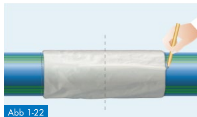
Abb 1-22 Positionieren der Schrumpfmuffe
