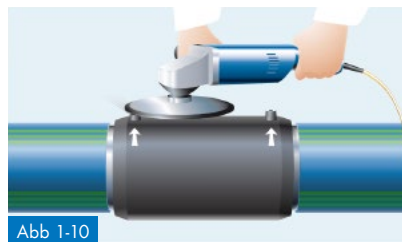
Abb 1-10 Entfernen der überstehenden Steckkontakte
