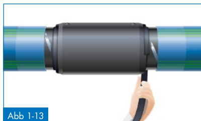
Abb 1-13 Abdichten des Ringspalt zwischen Rohr und Heizwendelmuffe
