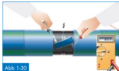
Messen des ohmschen Widerstandes, max. 0,5 Ohm
