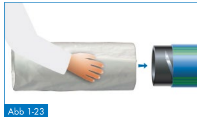
Abb 1-23 Schrumpfmuffe vor der Herstellung der Rohrverbindung aufschieben, Schutzfolie nicht entfernen
