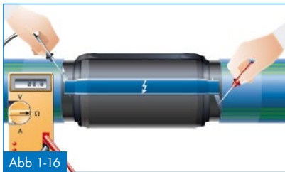
Messung des Durchgangswiderstandes der Verbindung und Protokollierung, max. 0,5 Ohm
