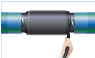
② Abdichtung des Ringspaltes zwischen Heizwendelmuffe und Rohr mit Füllerband
