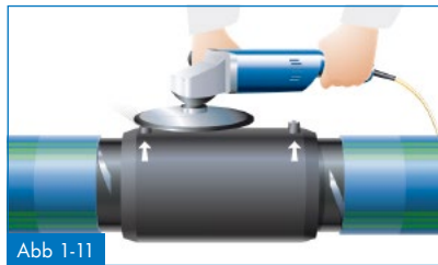
Abb 1-11 Entfernen der überstehenden Steckkontakte
