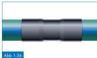
Abb 1-36 Mit Schrumpfmuffe geschützte Schweißverbindung
