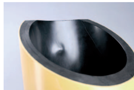
Bild 4: egeplast 9010 RCplus-Rohr nach einem Jahr Punktlastprüfung ohne Bruch (80°C, \sigma = 4 MPa)
